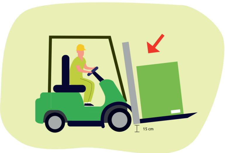
3 Lleva la carga a unos 15 cm del suelo, con el mástil completamente inclinado hacia atrás.
